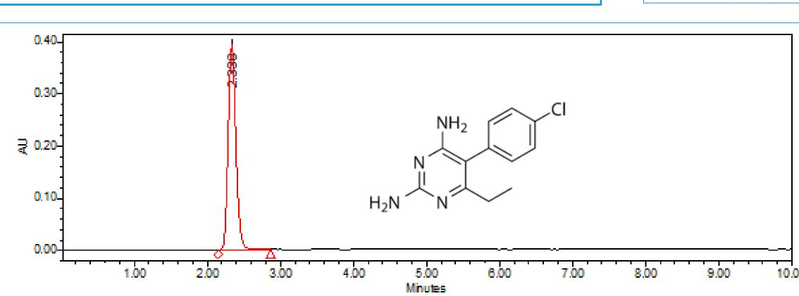
Aucun produit de dégradation détecté à λ=227 nm
